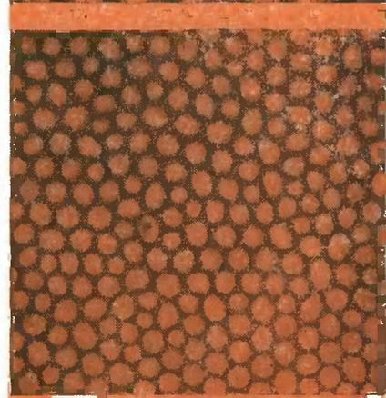
положно направлению вектора намагниченности. Такая взаимная ориентация элементарных магнитных стрелок и размагничивающего поля энергетически невыгодна. При разбиении на домены на поверхности образца будут существовать магнитные заряды разного знака, поэтому создаваемые ими размагничивающие поля компенсируют друг друга внутри образца; одновременно уменьшится энергия полей рассеяния.
